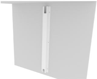
Accesorio metálico para subida / bajada de cables que se une al panel mediante tornillos directos. Alberga el cableado en el hueco que se forma al unirlo al panel. Medidas: 712 x 121 x 76 mm. Acabados: blanco, aluminio texturado o titanio.
