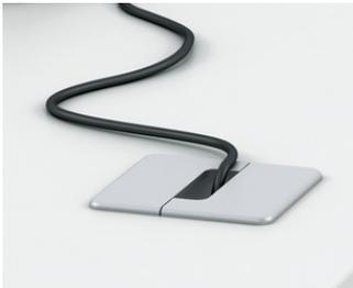
Tapa pasacables compuesta por dos piezas de inyección de plástico (ABS) de fácil montaje. El diámetro interior es de 80 mm., las dimensiones exteriores son 94 x 94 mm. Dispone de un hueco central por el que pasar los cables. Acabados: blanco, aluminio o negro.
